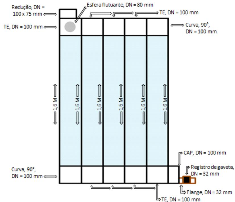
A quantidade e/ou altura dos tubos deve ser dimensionada de acordo com o tamanho da área de captação do telhado. Esse dispositivo deve ser instalado em uma base de concreto e estabilizado chumbando-o com braçadeiras na parede ou em vigas, conforme ilustrado abaixo.
