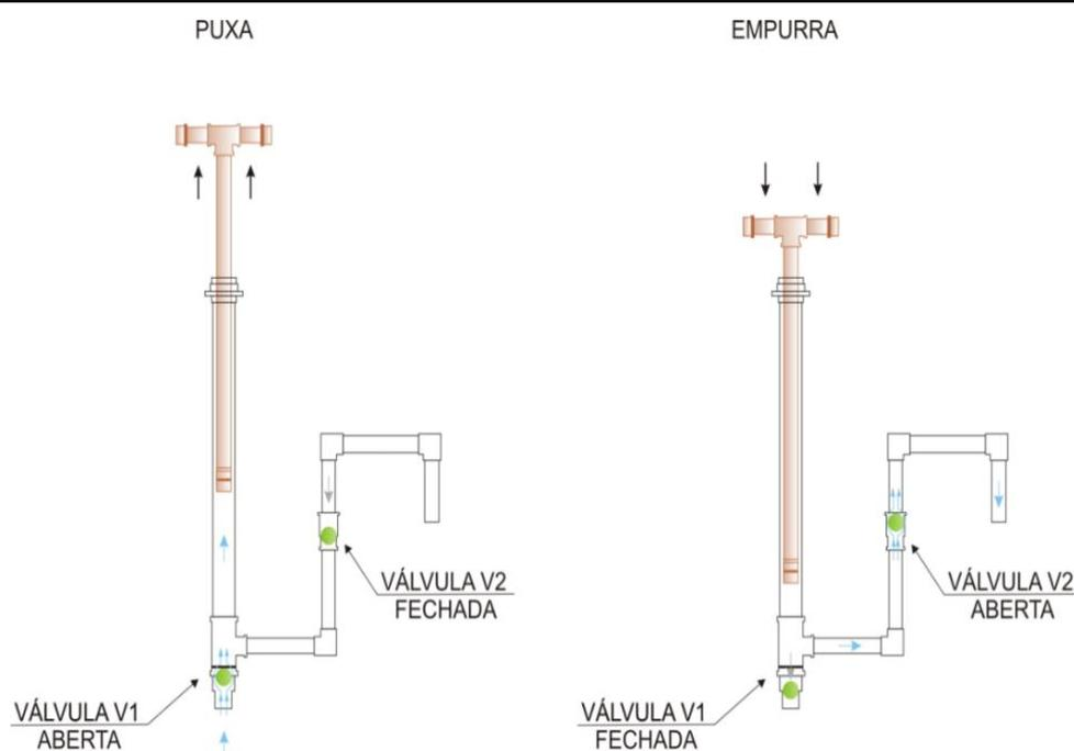
As válvulas de retenção servem para direcionar o fluxo da água durante o “puxa-empurra” no cilindro, ou seja, a água entra por uma válvula (V1) e sai pela outra (V2), seguindo uma única direção, conforme ilustrado na figura abaixo.
